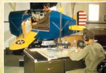
Simulation en vol dans le C-3 Link Trainer, U.S. Army Air Forces.
